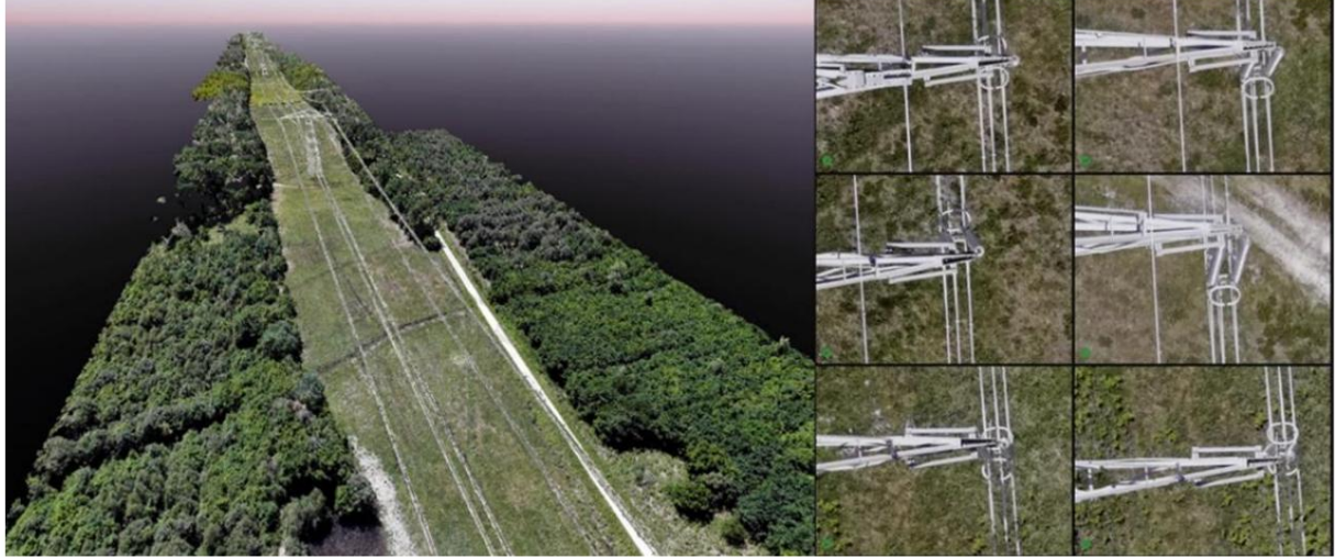
고전압 전력선 검사 ANAFI Ai로 캡처, PIX4Dmatic으로 처리 - 장면 크기: 4060 x 60 x 70 m(13,320 x 200 x 230 ft) - 이미지 2,172개 GSD: 1.3 cm/px - 고도: 90 m(295 ft) ) - 전면/측면 오버랩: 90% / 65%
